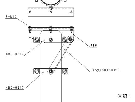
1. 使用材料:STK-400、SS400とする。 2. 表面処理:溶融亜鉛メッキ仕上げ(HDZ-55)
