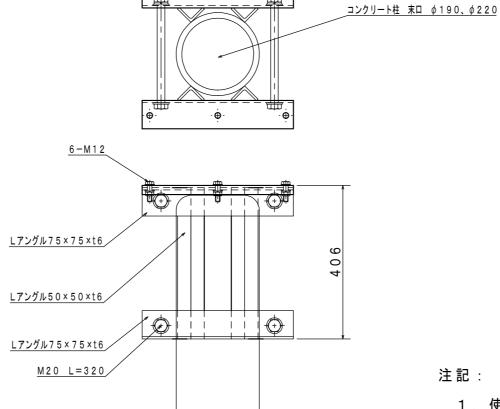
1. 使用材料:STK-400、SS400とする。 2. 表面処理:溶融亜鉛メッキ仕上げ(HDZ-55)
